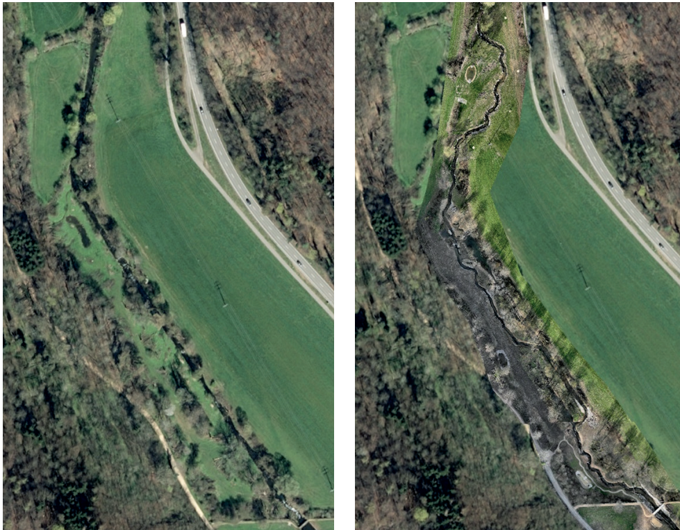
▲ Luftbild des Magdenerbachs vor und – hinein gelegt – direkt nach der Renaturierung (Frühjahr 2024) im Gebiet der neuen Bachaue in der Ängi.
